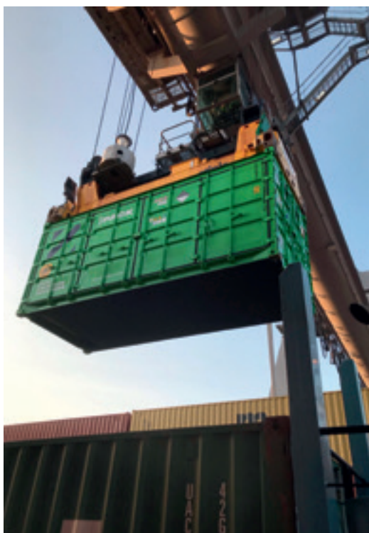
Wärtsilä Nederland B.V. met de verwisselbare batterijcontainer die binnenvaartschepen op groene stroom laat varen.
